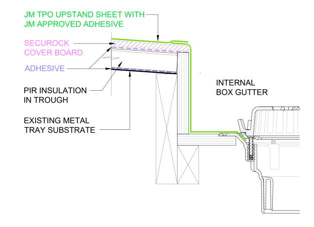
RECOVER ROOF - CASALI - TYPICAL INTERNAL GUTTER SCALE: NTS **EXTERNAL GUTTER OPTION DASHED**
