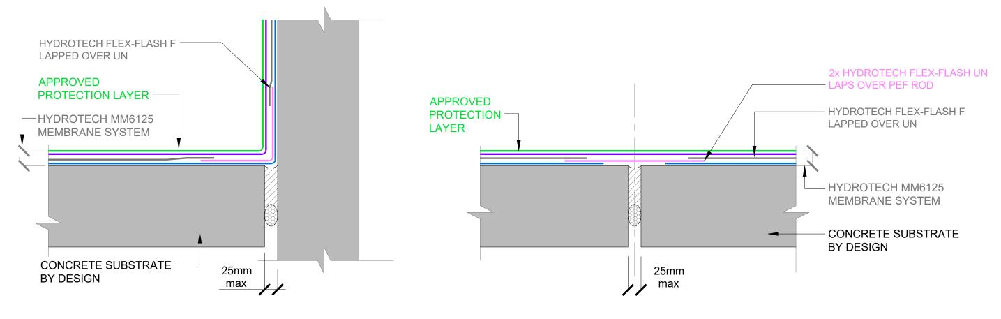
**HYDROTECH - EXPANSION JOINTS** SCALE: NTS JOINTS UP TO 25MM
